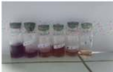
Gambar 2. Hasil Preparasi sampel daun Jati Belanda konsentrasi (20 ppm, 40 ppm, 60 ppm dan 80 ppm) setelah penambahan DPPH.
